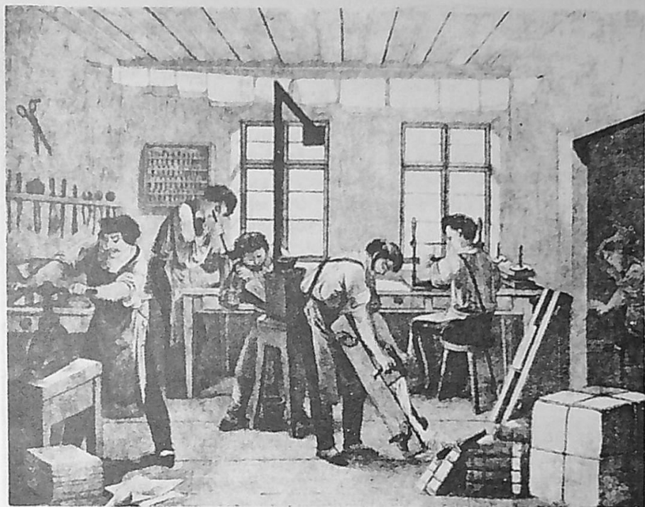
Bokbinderi 1850. Från vänster pressning, förgyllning, ässja, hyvling, häftning och hamring (i rummet till höger). Bild: Den svenska boken 500 år.
